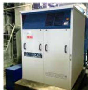
工业领域：世界领先的水泥和骨料供应商对 Robox Screw 螺杆压缩机的低速度大为赞赏，并且 Robuschi 的全新机组为其解决了螺杆压缩机的故障问题。在安装Robox Screw 螺杆压缩机之前，大气中的灰尘将进入之前的螺杆单元，当压缩机高速运行时（使轴密封件出现高温），会导致机器损坏。
