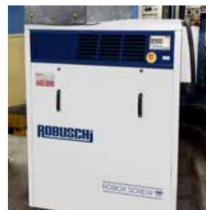
工业领域：欧洲领先的一次性塑料餐具和食品容器的生产商，与国际领先的经销链合作，用 Robox Screw 螺杆真空压缩机取代了旧的真空技术。该设备的工作条件为 300 mbar (a)，具有始终如一的节能表现（与以前的技术相比，节能高达 30 kw/h）。
