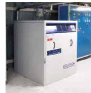
Ein bekannter Nudelhersteller installierte Robox Screw für die Pneumatische Förderung von Mehl und Zucker, vor allem wegen der niedrigen Verdichtungsendtemperatur, die das geförderte Material schont, und der herausragenden Energieeffizienz.
