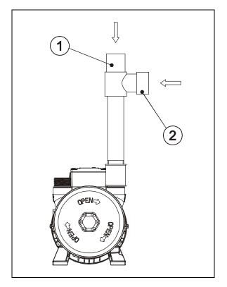
Fig. 19: Gas ejector
